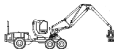
FIGUR 2. Engreppsskördare med hängande hytt. Bild: HEMEK.
