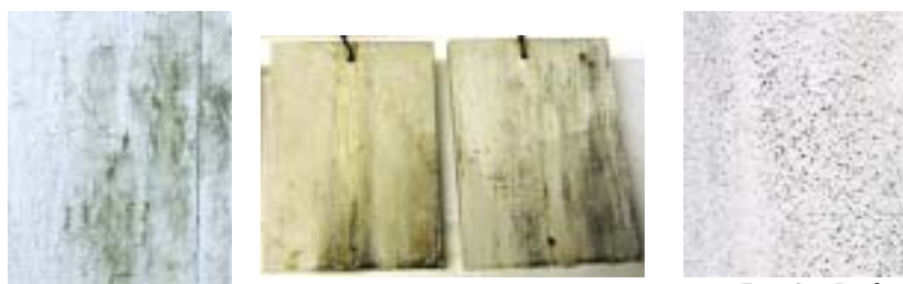
FIGUR 2. Från vänster syns algangrepp, mindre och större mögelangrepp samt angrepp av blånadssvamp ("svartmögel").
