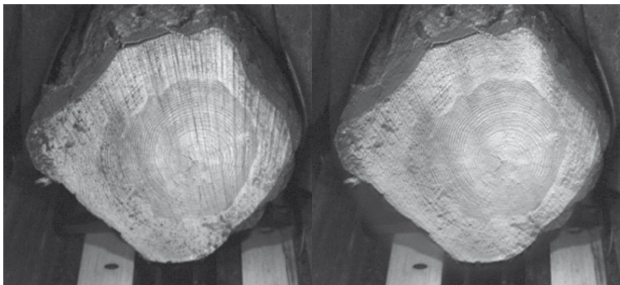
FIGUR 2. En ändyta med mönster från sågningen (vänster) och resultatet efter att mönstret har reducerats med den automatiska metoden (höger). Foto: Kristin Norell.
