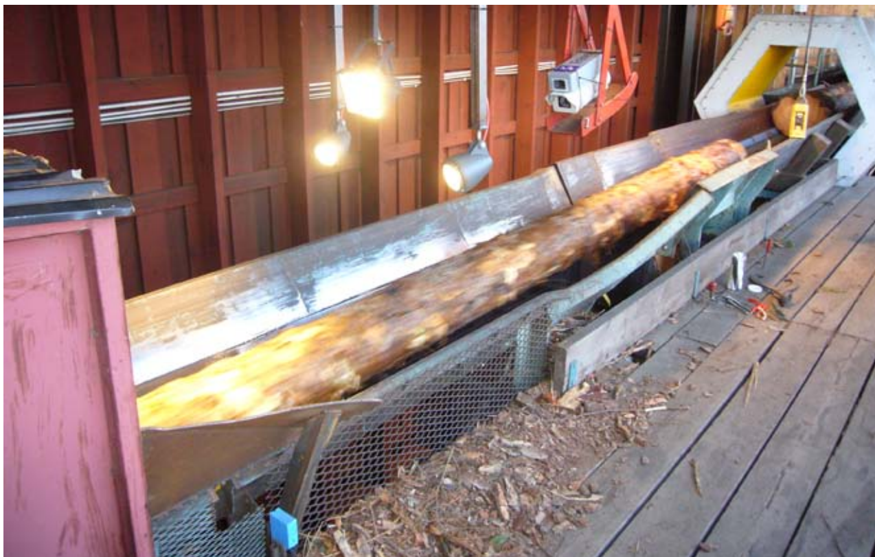
FIGUR 1. Fotografering av ändtytor på sågverk. Kameran är monterad på den röda släden som hänger från taket. Lamporna belyser ändytan på en passerande stock, och en bild tas när stocken är i rätt läge, vilket regleras av en fotocell. Foto: Joakim Lindblad.
