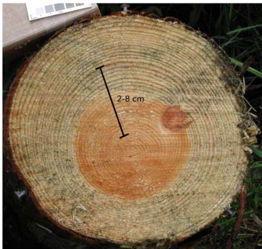
FIGUR 4. Mätområdet för antalet årsringar illustrerat på en ändyta från tall fotograferad med systemkamera. Foto: Kristin Norell.
