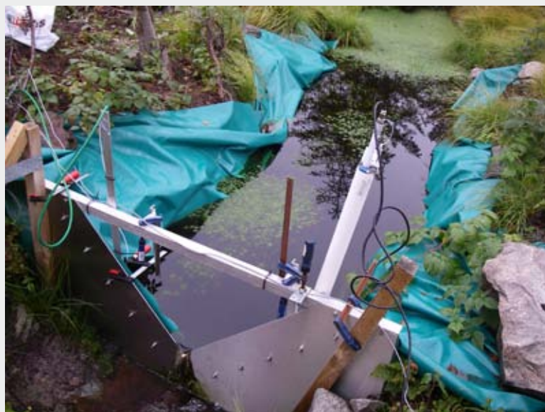
FIGUR 1. Dammkonstruktion med V-överfall och mätinstrument. Foto Karin Eklöf.
