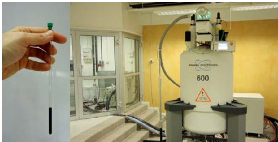
Figur 3. Glasrör med ett jordextrakt från boreal skogsmark (t.v.), som sedan förs in i NMR-spektrometern (t.h.) för att erhålla 31 P NMR-spektrum. Foto Andrea Vincent.
