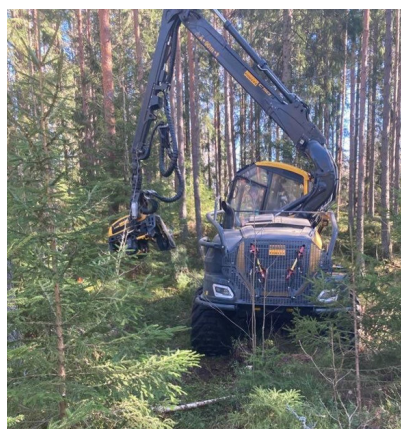
Figur 1. Skördaren är en stor 23 ton Ponsse Scorpion. Foto: Tobias Karlén
