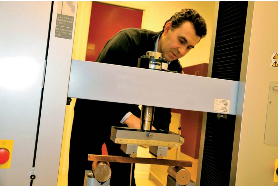
Nasko Terziev mäter böjhållfasthet hos tropiska träslag. De mekaniska egenskaperna bestämmer i hög grad vilken användning virket får. Foto: Hans Fryk
