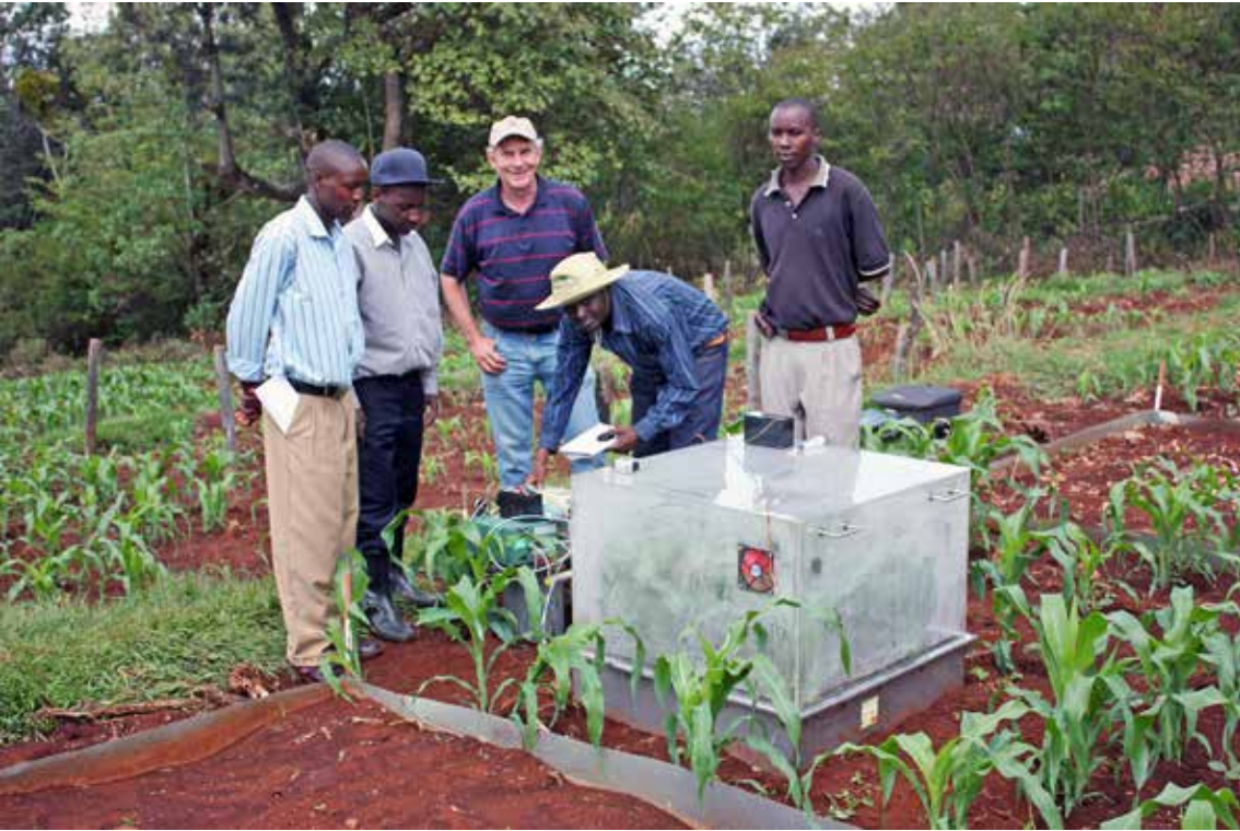
Inmärkning av gröda med isotopen kol-13 för studier av markens näringsväv i ett kenyanskt fältförsök. Foto: Privat
