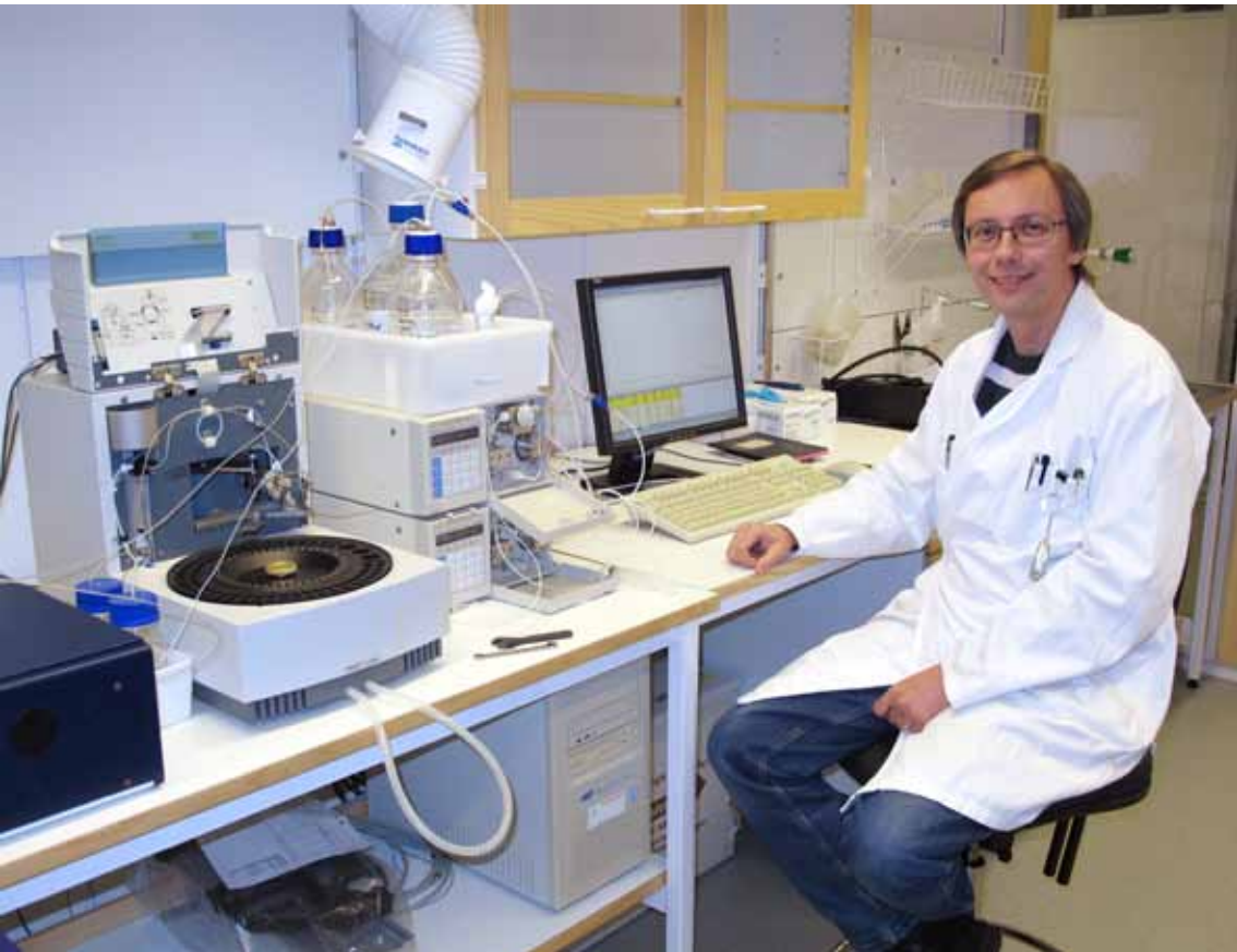
Utrustningen på bilden används för att analysera molekylvikten hos \beta -glukan. Foto: Janicka Nilsson
