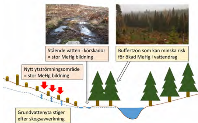
Figur 1. En stor nybildning av MeHg kan ske i nya utströmningsområden och i stående vattensamlingar efter en avverkning. Om den ökade MeHg-bildningen leder till ökning också i ytvatten, beror på den hydrologiska kopplingen mellan platsen för nybildning av MeHg och vattendraget. Transporten av MeHg kan minskas av en buffertzonen av orörd skog och/eller våtmark runt vattendraget. Topografi, främst lutning, avgör lokalisering och storlek av nya utströmningsområden. Kollage: Karin Eklöf.
