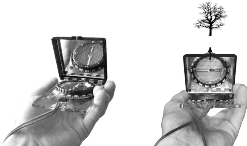
Figur B10. Eftersom transekterna alltid ligger i rak nord-sydlig eller öst-västlig riktning kan kompassen alltid ställas in på 360 eller 90 grader. Håll kompassen plant, se till att kompassnålen ligger rätt och ta sikte på ett terrängföremål.
