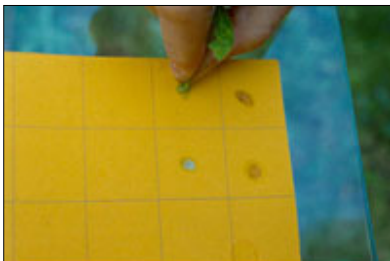
Snabbt screeningtest av lupin-alkaloider. Läskapper färgat med Dragendorff's reagens reagerar på alkaloider så att det färgas rött.
