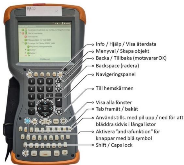
Figur 20. Datasamlaren Allegro3 som introducerades i Riksskogstaxeringens fältarbete år 2021.
