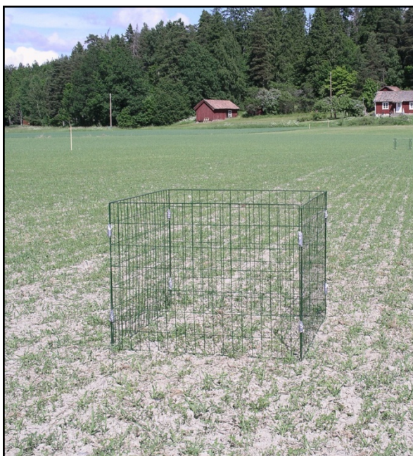
Fig. 12. Som uthägnad användes nätburar som bestod av enkla kompostgaller, 0,9 x 0,9 m. Burarna förankrades i marken med hjälp av tältpinnar.
