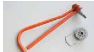
Bild 18. En trådvinda underlättar hanteringen av ståltråden avsevärt.
