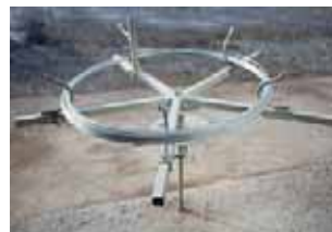
Bild 18. En trådvinda underlättar hanteringen av ståltråden avsevärt.
