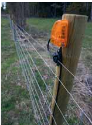
Bild 25. Olika typer av strömbrytare som monteras direkt på stängslet.
