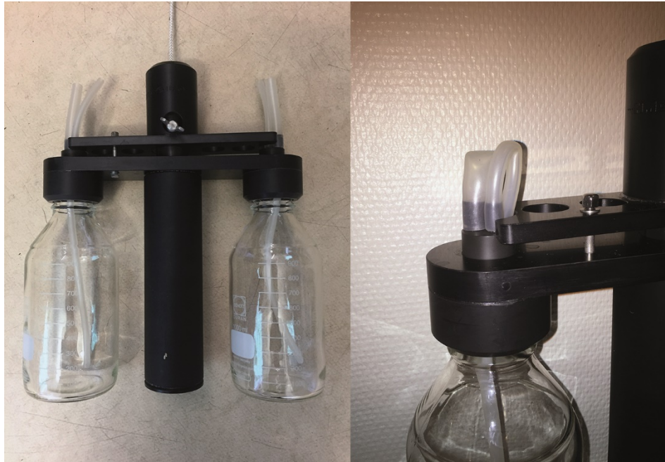
Figur 28. En del vattenhämtare kallas för ”kontaminationsfria”. ”Limnos”-modellen från Hydrobios har två slangar i locket som öppnas upp då hämtaren kommit till önskat djup (foto: Patrik Bohman, SLU).
