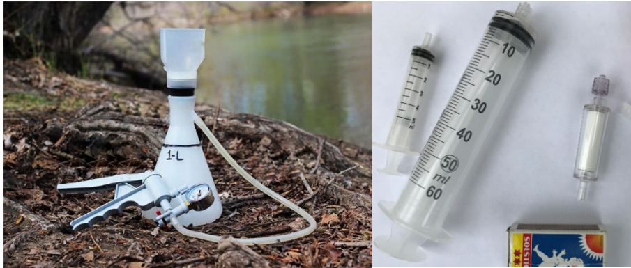
Figur 37. Vänster: Handpump med vakuumfiltrering (källa: Laramie et al. 2015b). Höger: Injektions-sprutor (20 respektive 50 ml) och filterkapseln Sterivex (foto: Per Sundberg, ©SeAnalytics).
