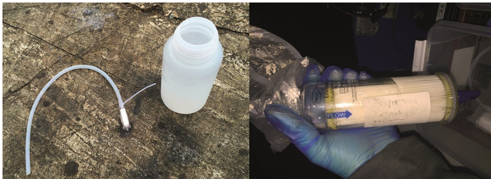
Figur 36. Vänster: Sterivexfilter kopplat med buntband till en slang för filtrering med peristaltisk pump och skruvdragare. Höger: Envirochekfilter är betydligt större och filtrerar mer vatten än Sterivex (foto: Patrik Bohman, SLU).
