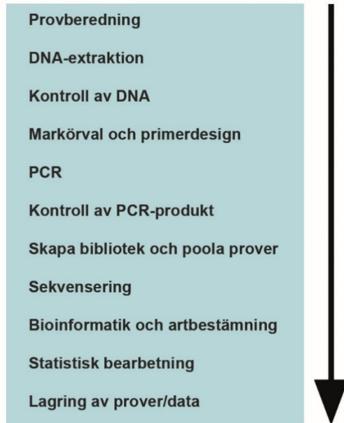
Figur 52. Flödesschema över de olika momenten vid analys av eDNA på ett laboratorium (illustration: Patrik Bohman, SLU).
