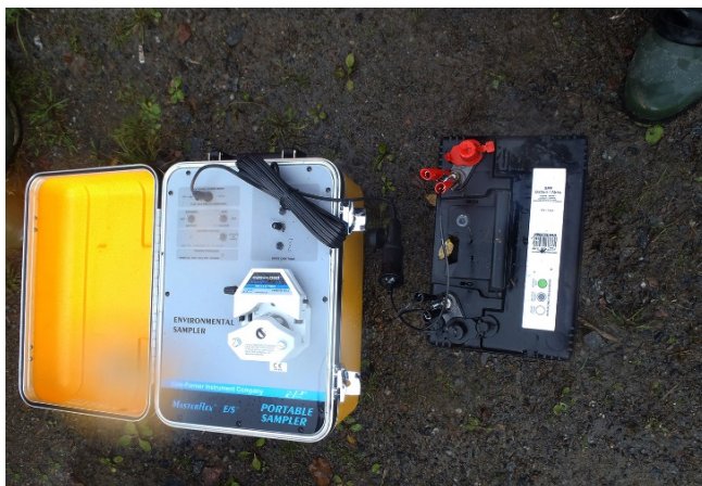
Figur 39. Cole-Parmers Masterflex E/S portable sampler (115 VAC) uppkopplat till ett externt batteri (foto: Patrik Bohman, SLU).
