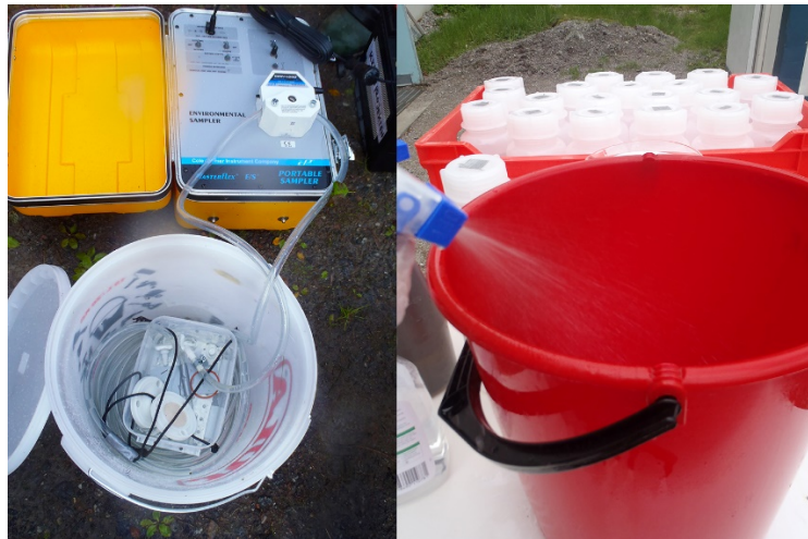
Figur 20. Vänster: desinficering av utrustning i ett hinkbad. Höger: besprutning med desinficeringslösning (foto: Patrik Bohman, SLU).
