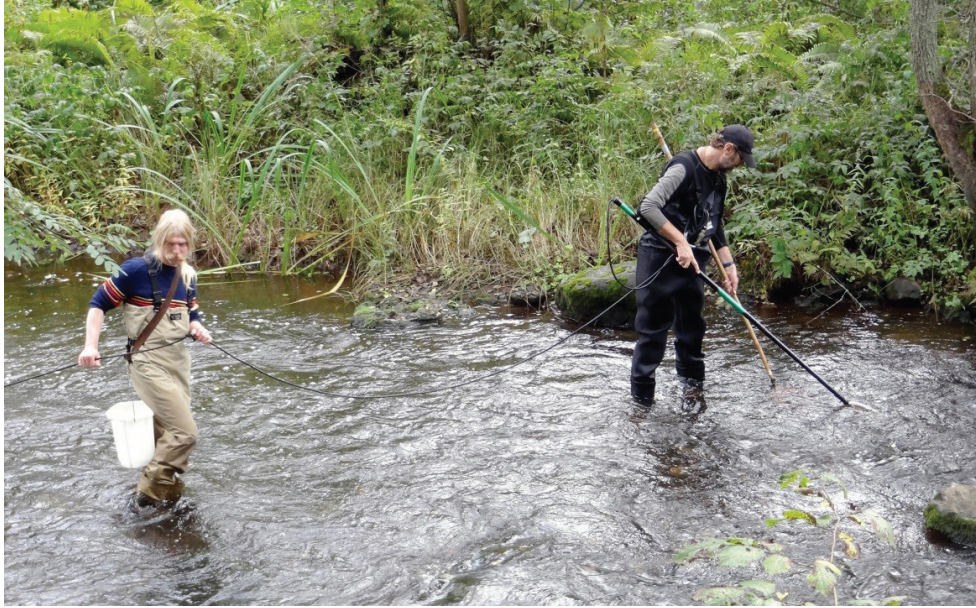
Figur 4. Elfiskeundersökning i Svartån, Örebro. Längst fram går personen (Martin) med elfiskestaven (pluspolen, anoden) och bakom staven håller han häven. Fisk som kommer fram fångas och lämnas till personen med hinken (Daniel). På land står ett elverk som genererar 220 V växelström och ett elfiskeaggregat som omvandlar denna till en rak likström på 300–1 000 Volt. Likström används för att fisken skall fångas utan skador. Den bakre personen sköter också kabeln mellan elfiskestaven och elverket. Foto: Erik Degerman.
