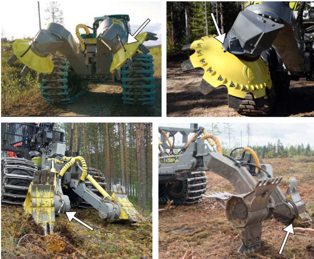
Figur 6. Mekaniserad skogssådd genom såddrör monterade på moderna harvaggregat (överst) och höglägningsaggregat (nederst). Harvaggregat med standardharvtallrikar (med grävmaskinständer, vänster) och en nyutvecklad harvtallrik (med slitstarka plattor, höger). Höglägningsaggregat med sidomonterade såddrör med standardmässiga treuddiga rihjul (med grävmaskinständer, vänster) och nyutvecklade treuddiga rihjul (med ”nästan-mikropreparerande” skärtänder på ett rihjul och slitstarka plattor på det andra rihjulet, höger). De vita pilarna visar var fröna kommer ut. Foton: Bracke Forest AB.
