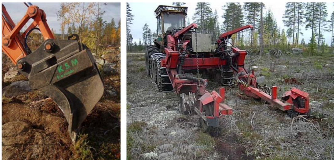
Figur 7. Exempel på specialaggregat för mekaniserad skogssådd: KSM-skopan (Kranspetsmonterad såddskopa, vänster) på grävmaskin för riktad skogssådd i långfläck; HuMinMix (HumusMineraljordMix, höger) på skotare för kontinuerligt framryckande radsådd i frästa, mikroreparerade spår. Foto: Ida Nilsson och Tomas Nordfjell.
