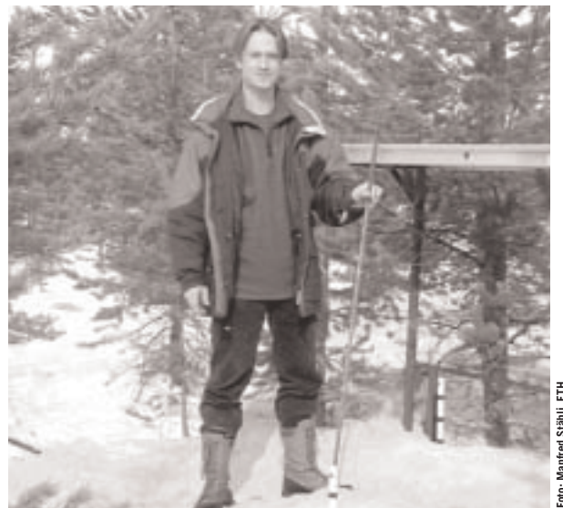
Per-Erik Mellander på den kalla ytan. Instrumentet används för att mäta tjäl djupet i marken.
