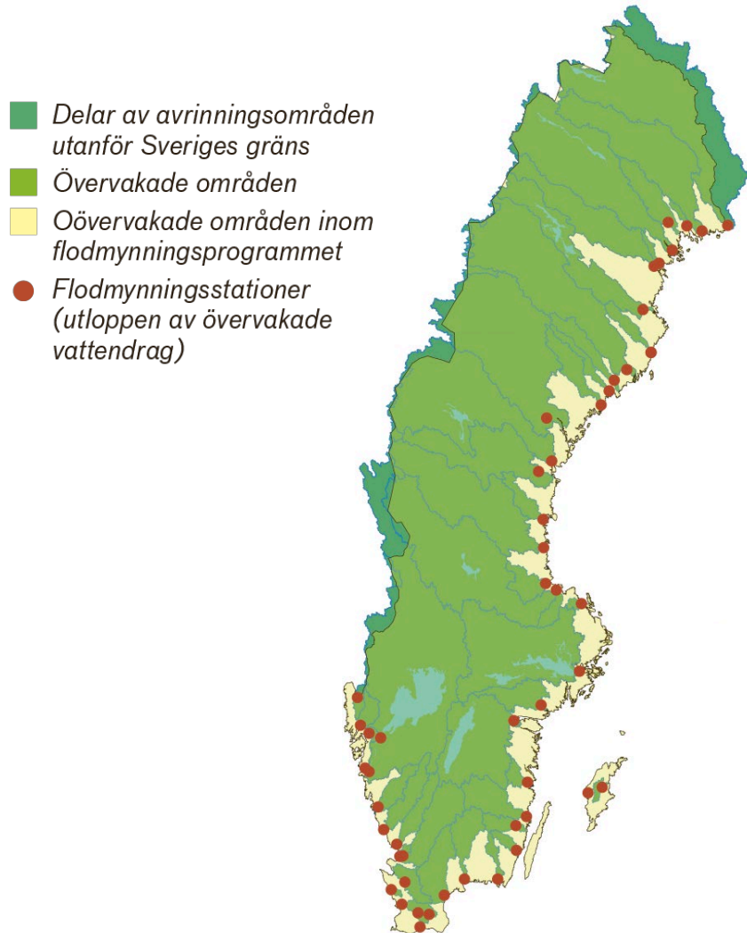
Flodmynningsstationer – övervakning i större vattendrags mynningar i havet
