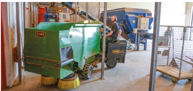
Fodertrucken tar sig fram i stort sett överallt i stallet och är därför ett värdefullt komplement. Maskinen utfodrar åt båda hållen och är även utrustad med soppsalsar och saxlyft.
