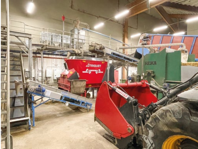
Den stationära mixern omgiven av rivarbord, halmhack och bandfoderfördelare. Mixern har även utmatning för lastning av exempelvis vagn, foderkärra, och fodertruck.
