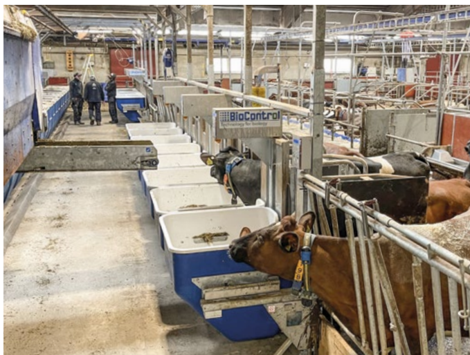
Vågförsedda fodertråg som ger individuell registrering av kornas grovfoderförbrukning.
