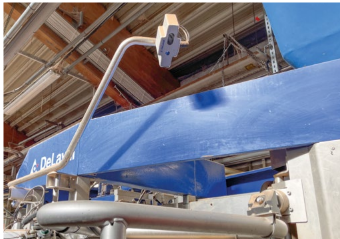
Kamera för hullbedömning. Registreringen görs då kon lämnar mjölkningsroboten.
