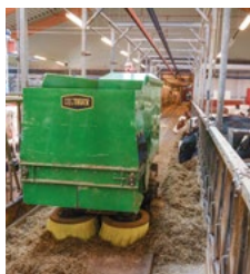
Fodertrucken tar sig fram i stort sett överallt i stallet och är därför ett värdefullt komplement. Maskinen utfodrar åt båda hållen och är även utrustad med soppsalsar och saxlyft.
