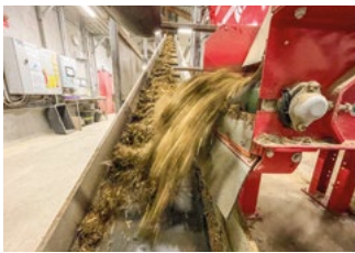
Den stationära mixern omgiven av rivarbord, halmhack och bandfoderfördelare. Mixern har även utmatning för lastning av exempelvis vagn, foderkärra, och fodertruck.
