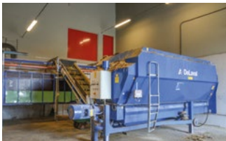
I det kompletterande beredningsutrymmet finns en stationär foderblandare med liggande skruvar.
