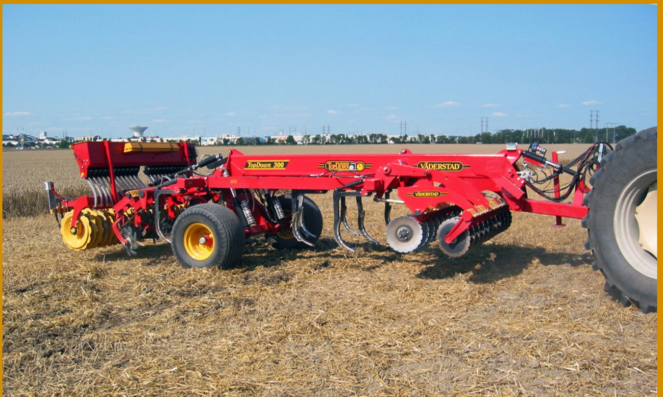
Figur 1. Exempel på kultivator med stela pinnar avsedd för djup bearbetning. Foto: Johan Arvidsson
