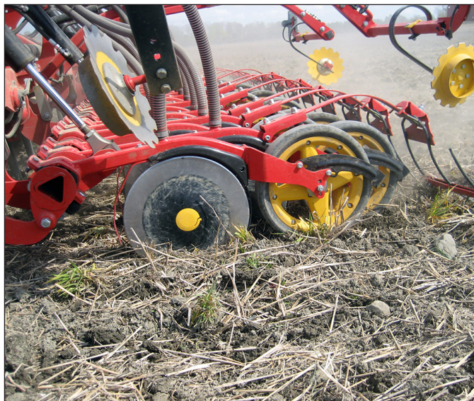
Figur 3. Bearbetningsdjupet bestäms främst av behovet att blanda in skörderester för att kunna genomföra sådden på ett bra sätt. Foto: Johan Arvidsson.
