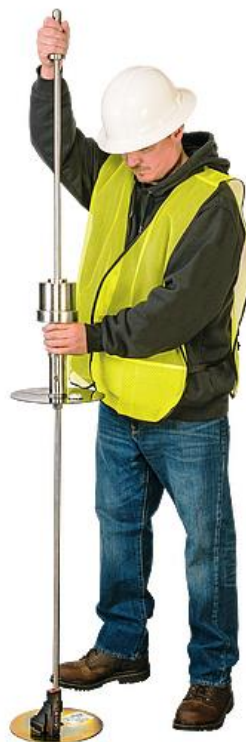
Mätning med dynamisk konpenetrometer (till vänster) samt lättviktsdeflektometer (till höger).
