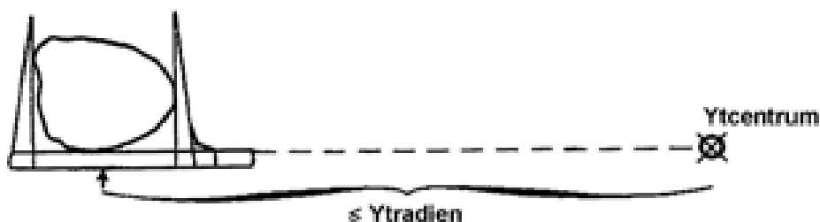
Figur 8.3 Klavning ska ske i brösthöjd (dvs. på 1,3 meters höjd) över trädets gröningspunkt med klavens linjal riktad mot provytacentrum. Klavningen görs på träd vars gröningspunkt ligger inom ytans radie.
