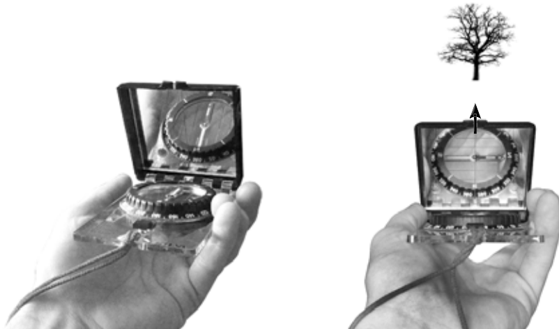
Figur B1. Eftersom transekterna alltid ligger i rak nord-sydlig eller öst-västlig riktning kan kompassen alltid ställas in på 360 eller 90 grader. Håll kompassen plant, se till att kompassnålen ligger rätt och ta sikte på ett terrängföremål.
