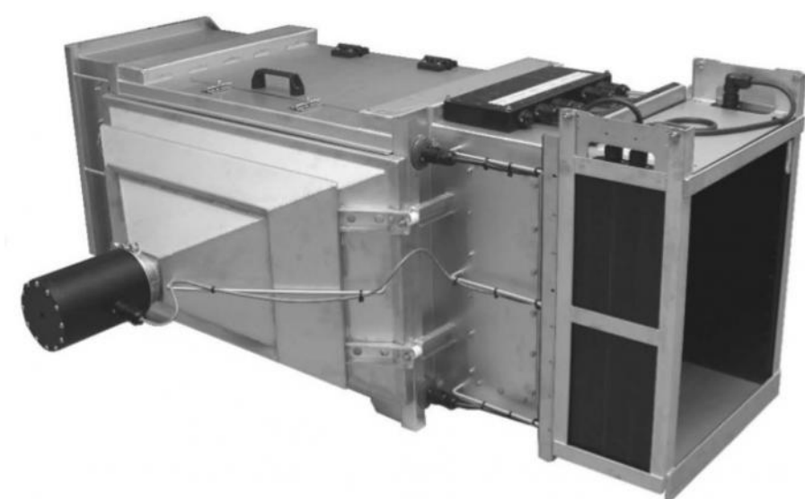
Figur 2. Vaki RW fiskräknare. Till höger i bilden ses skannerenheten med två svarta plattor i en kassett. Till vänster syns den långa fototunneln med en konformad luftfylld kammare på sidan. I konens spets sitter en nätverkskamera i det runda svarta kamerahuset.
