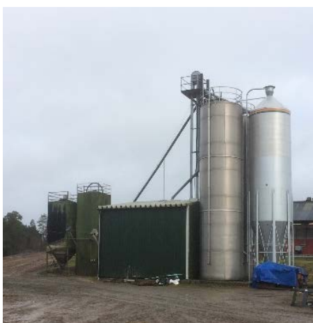
Bilderna visar foderanläggningen med silos, tippgrop och kvarn.
