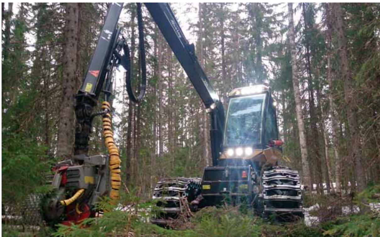
Figur 4. Stora skördare behövs i blädningsarbetet eftersom de ska hantera grova träd. Bilden är från försöket i Sidensjö, Ångermanland. Foto Rikard Jonsson.
